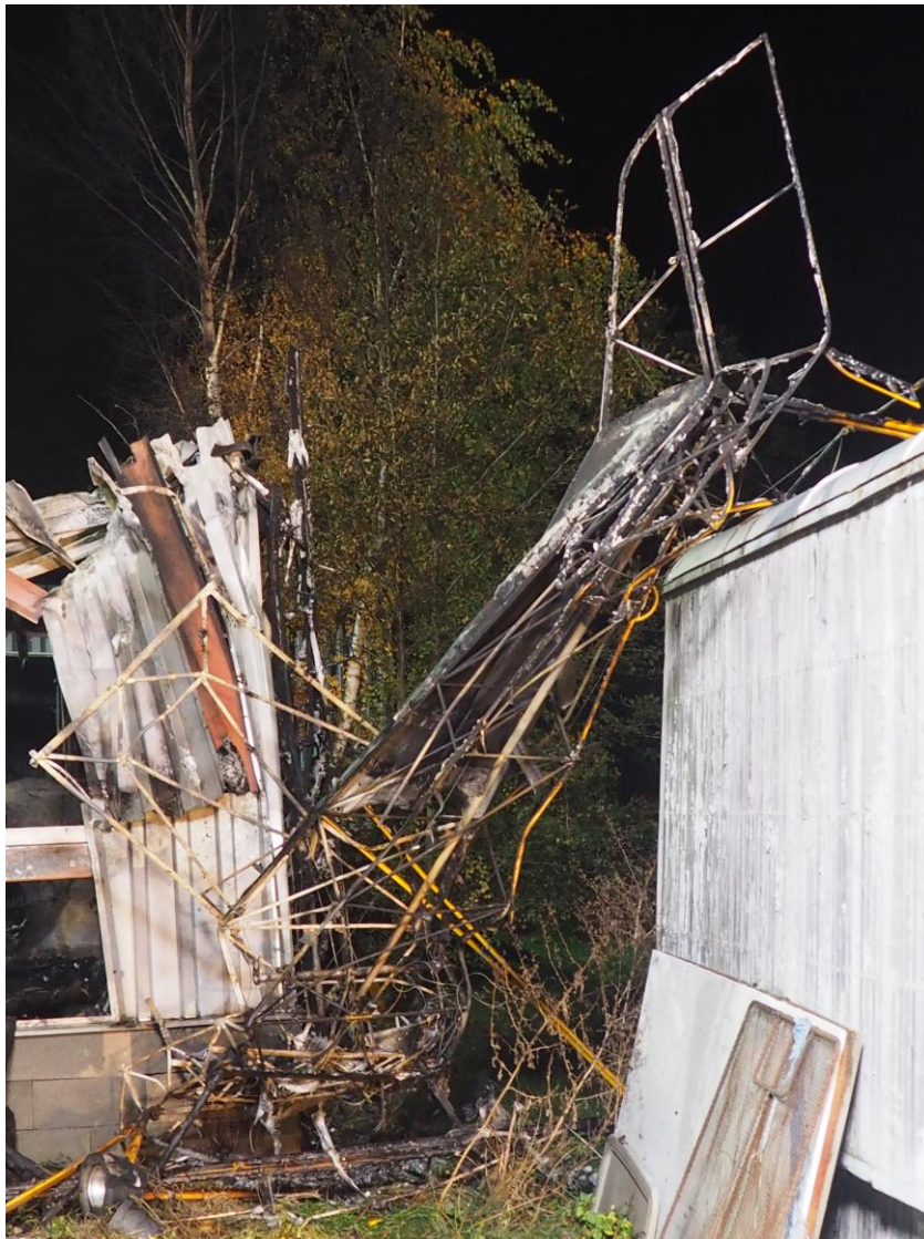
Obr. 1 – Trosky UL letounu na místě dopadu
